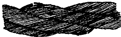
Рисунок 1. Обрывы и смещения проволок каната крестовой свивки
