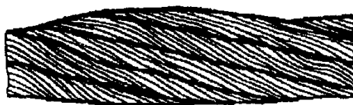
Рисунок 13. Местное увеличение диаметра каната
