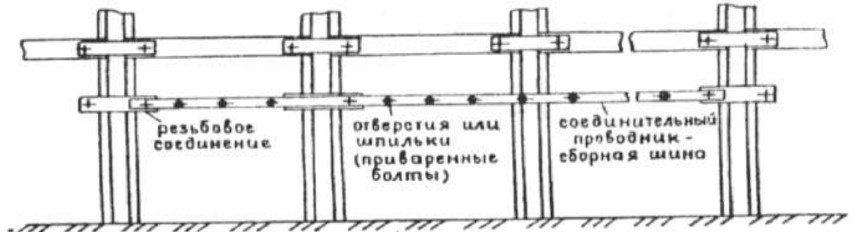
Устройство местного заземлителя с использованием сборной шины в качестве соединительного проводника и крепления его к раме крепи
